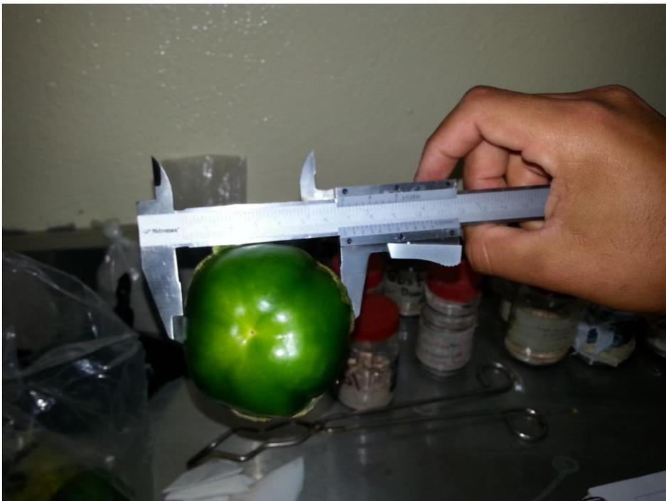
Imagen 29 medida del diámetro utilizando un Vernier
